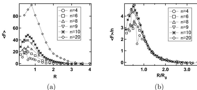
図 2: 粗視化粒子間平均力。(a) MD によって計算された平均力。(b) (a) を粒子数と慣性半径でスケールしたものの。
