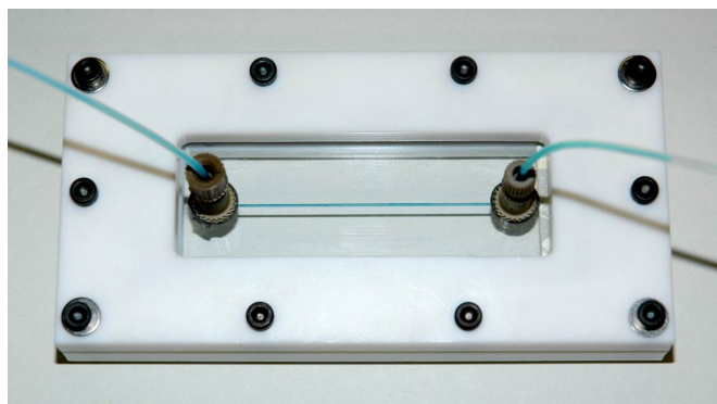
図1 光触媒担持マイクロリアクター。流路幅 500\mu\text{m} 、深さ 100\mu\text{m} 、長さ 50\text{ mm} 。
