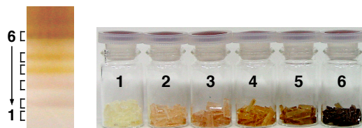
図 3. \text{Au}:\text{GTR} クラスタ泳動後のゲルの写真 (左)。ゲルを切り取ったのち (右)、水に浸して各フラクションに含まれるクラスタを回収する。
