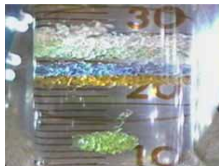
図2 磁気アルキメデス効果により分離された実用ガラス材料
