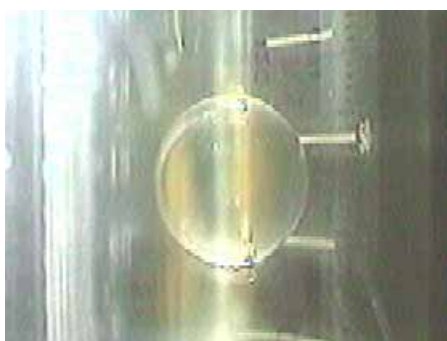
図1 磁気アルキメデス効果による水の浮上。周囲の環境は12気圧に加圧された酸素ガス。
