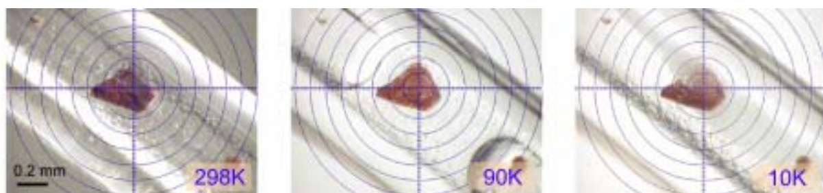
図2 測定中の 1 の写真(90Kでは液体 \text{O}_2 、10Kでは固体 \text{O}_2 が見える)。
