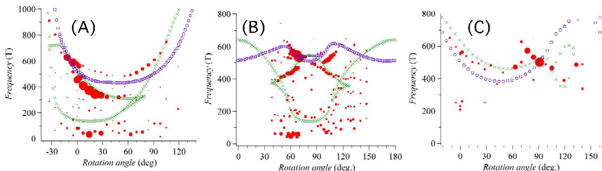
図3 R16, gap = 0.105 eV で計算したフェルミ面の極地断面積 (A) a軸回転、磁場は b\*-c\* 面内 (B) b\* 軸回転、磁場はa-c面内 (C) c軸回転、磁場は a\*-b\* 面内
