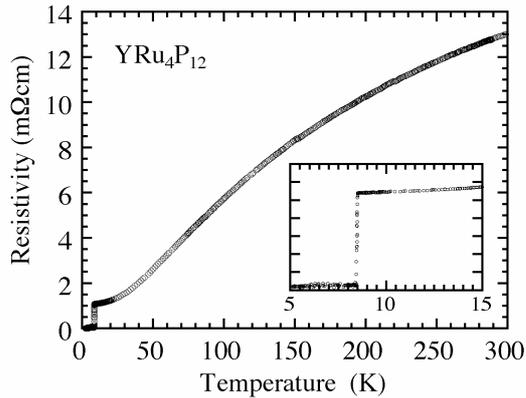
図4 YRu<sub>4</sub>P<sub>12</sub>の電気抵抗率の温度依存性
