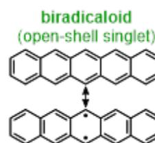
**Figure 2.** ペンタセンの開殻一重項電子構造
