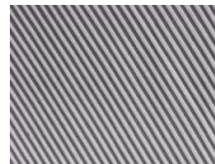
図 2 In-lens 検出器によるグラフェンナノリボンの SEM 観察像
