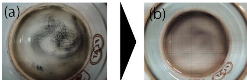
図 1 (a)蒸着直後と(b)蒸着から 1 日経過してからのサンプルの様子
