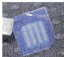
図1 フレキシブルなセルフコンタクト有機トランジスタと(BTBT) 2 PF 6 の構造
