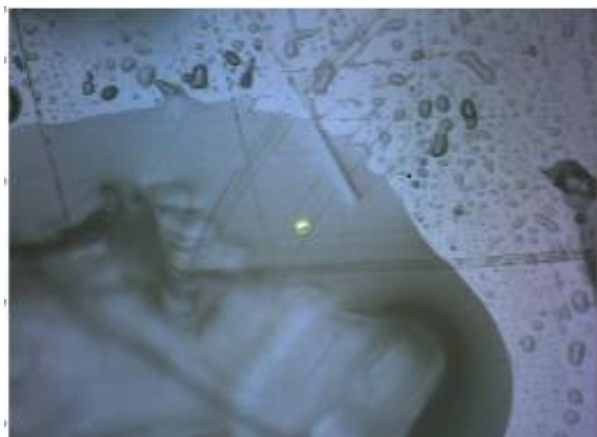
Fig.3. レーザーラマン顕微鏡による S -IBU/LID 混合物が固相と液相に分離した状態の観察
