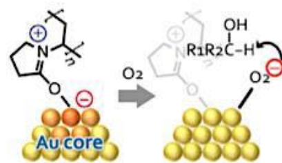
Fig. 1 提唱されている Au:PVP の酸化触媒反応機構の概念図[1]
