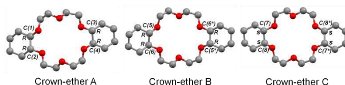
図 2 結晶 1 内に存在する DCH[18]crown-6 の立体配置
