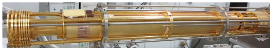
図 4 NMR セルの概観図 (全長 940 mm)
