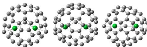
図3. \text{Lu}_2\text{C}_2 内包フラーレンの内包クラスター構造
