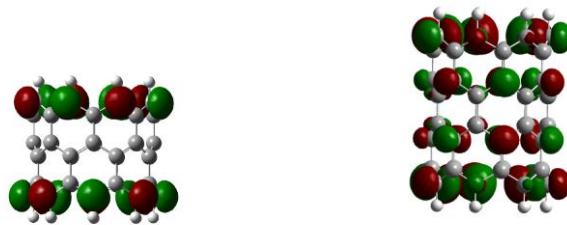
図2 (8,0)_2 ジグザグナノチューブのHOMOと (7,0)_3 ジグザグナノチューブのHOMO
