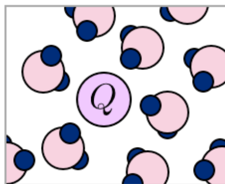
図1. イオン電荷 Q に応じて溶媒は分極する。
