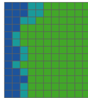
図5 \beta' -(ET) 4 [Ga(C 2 O 4 ) 3 ](H 3 O)PhNO 2 のマッピングデータ(mesh=10 \mu\text{m} )。緑と青は図4に対応している。青緑の部分は両者の中間的挙動を意味する。
