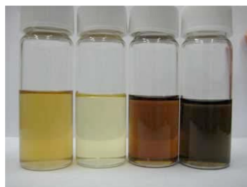
図 2 fs レーザー照射後試料の写真 左から順に四塩化炭素溶液 (30 分照射、2 時間照射)、トルエン溶液 (30 分照射、2 時間照射)
