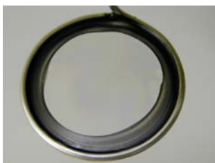
図 1 磁場中（5 T， -900 \text{ T}^2/\text{m} ）で調製された MWCNT がドーブされた PVA 薄膜（φ18）。
