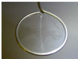
図 3 微小重力下 (5 T, -900 \text{ T}^2/\text{m} ) で調製された酸化チタン薄膜.
