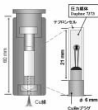
Fig.1 加圧下熱容量測定システム概念
