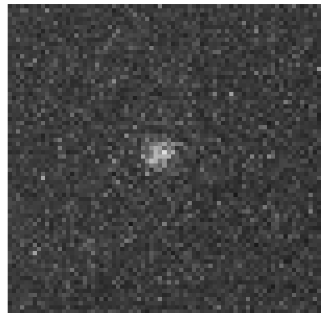
図2：図1の金ナノプレート上をSTM で測定( V_t = -2.47\text{V} , I_t = 0.134\text{nA} )しながら同時に測定した CCD 画像
