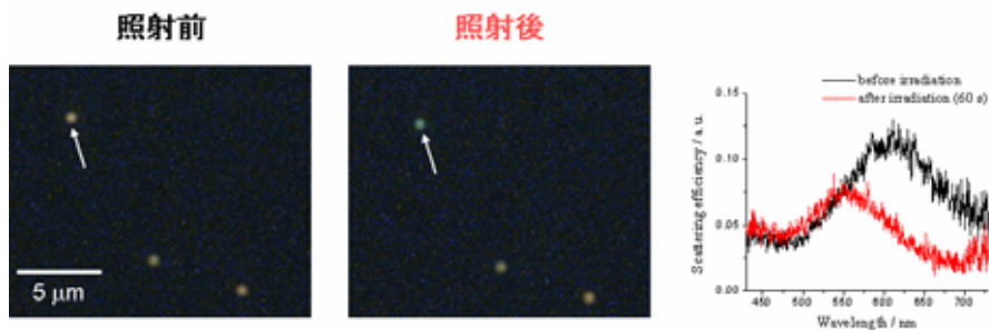
Fig.2 フェムト秒レーザーの基本波照射前後の金ナノ粒子の暗視野像およびSPR散乱スペクトル (照射光強度: 150 \mu\text{J}/\text{cm}^2 pulse)
