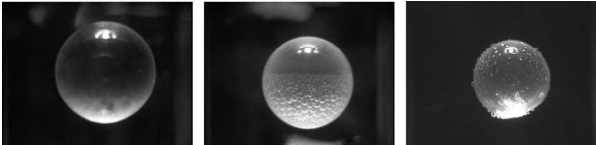
図 2 (左). シクロヘキサン滴の過冷却. 空気中の水蒸気が下部に凝縮.
