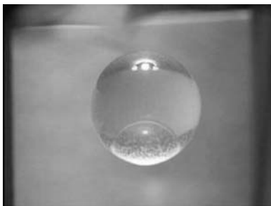
図 5. 微小重力空間におけるシクロヘキサン (上相) と水 (下相) の半球形界面.
