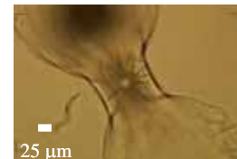
図.2 光圧によるPNIPAAゲルの体積相転移の様子。
